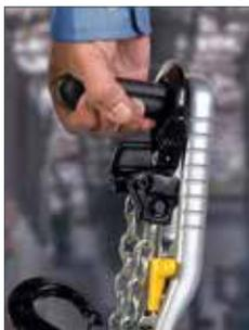
Ausgeklappt erleichtert der Kurbelgriff den Transport des Gerätes. Hierzu wird das Kettenendstück am Haken befestigt und dieser am ausgeklappten Griff eingehakt.
