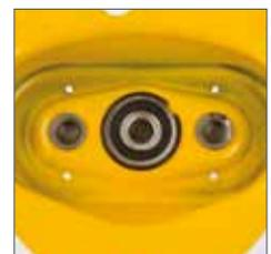
Kugellager im Getriebedeckel
