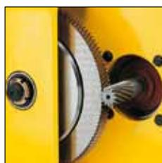
Getriebe mit Rutschkupplung
