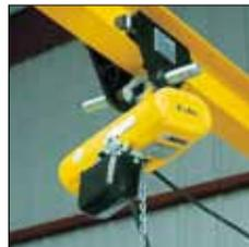
Kleinster und leichtester Elektrokettenzug, für eine Vielzahl von Anwendungsfällen.
